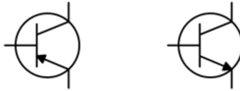
Рисунок 1.3 – Позначення БТ на електричних схемах
