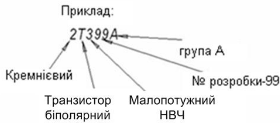
Рисунок 1.1 – Приклад маркування біполярного транзистора
