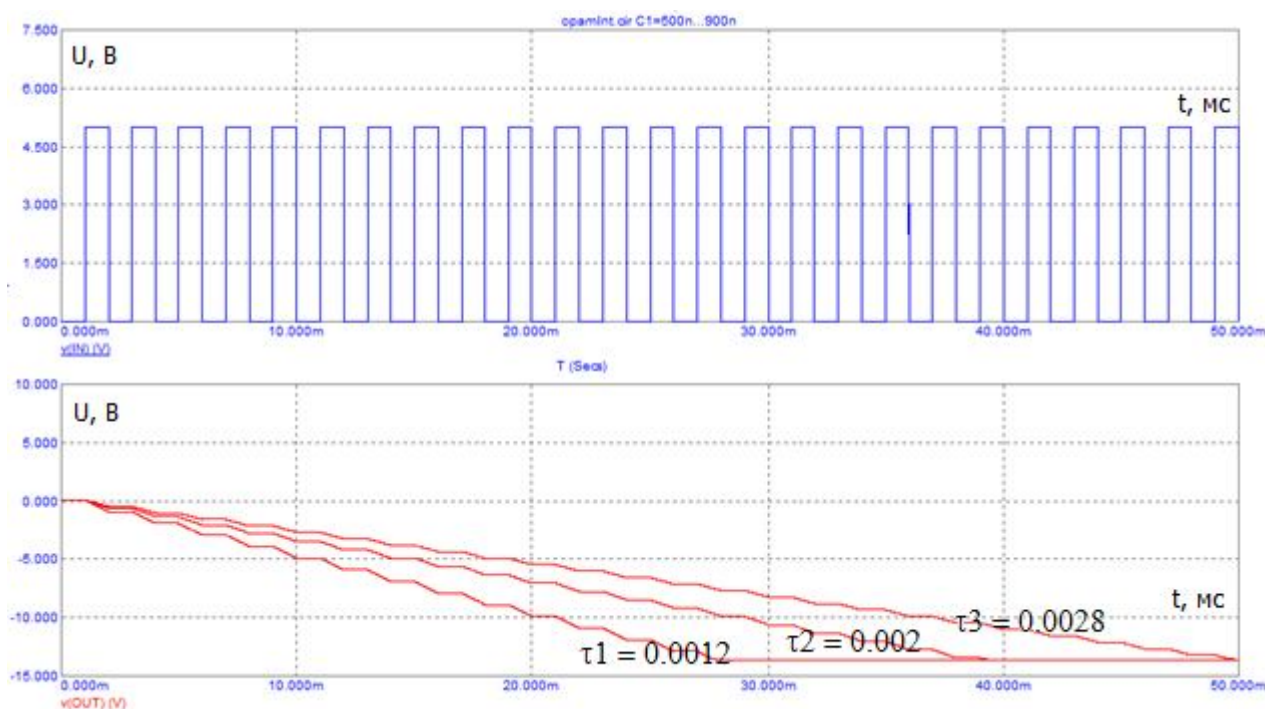
Рисунок 2.24 – Сімейство часових діаграм роботи активного ІЛ при зміні R1 (живлення операційного підсилювача увімкнене одночасно з подачею вхідної напруги)
