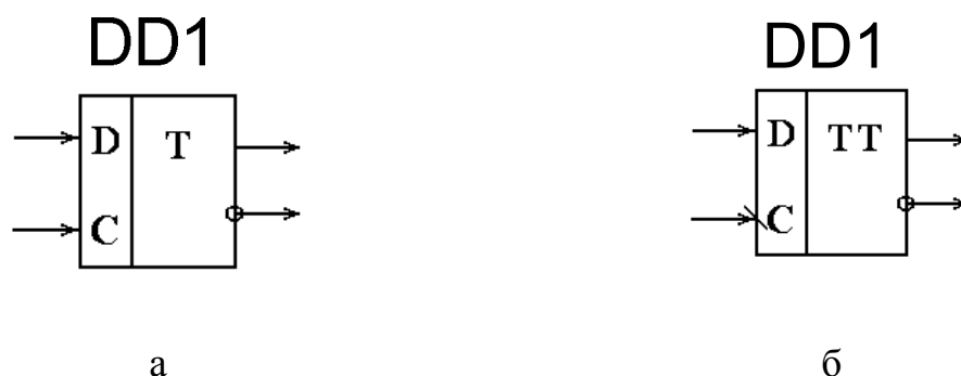
Рисунок 18.8 – Позначення D-тригера на електричних схемах:
