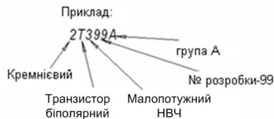
Рисунок 1 – Приклад маркування біполярного транзистора
