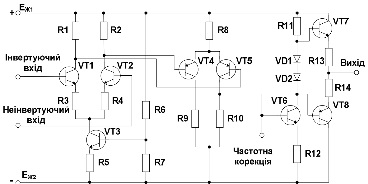
Рисунок 5 – Спрощена принципова схема ІМС ОП
