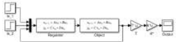
Рис. 2. Структурна схема з об'єднаним регулятором
