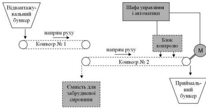
Рис. 1 – Схема конвеєрної лінії і принципу роботи відбраковування
