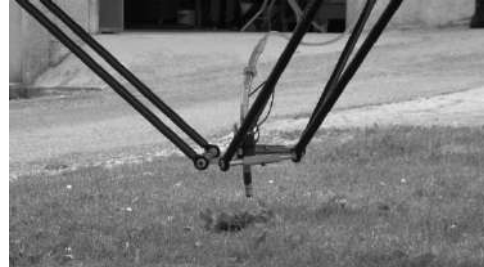
Рис. 2. Маніпулятор з під'єднаним шлангом
