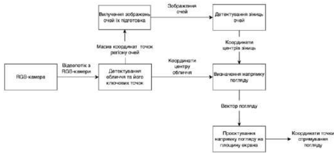
Рис. 1. Структурна схема узагальненої моделі відстеження погляду користувача вебзастосунків
