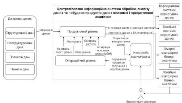
Рис. 1. Компонентна діаграма рівнів централізованої інформаційної системи обробки та аналізу даних
